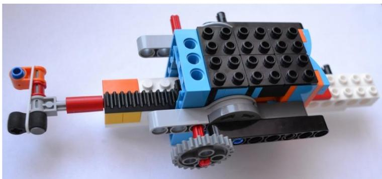
При соединении этих конструкции выполним жесткий крепеж в трех местах с помощью деталей и в четырех с помощью держателей. На рисунке ниже вы видите вид сверху: крепеж угловыми (синей и красными) деталями для надежности и крепеж серыми держателями, захватывающий сразу два кубика. В центре - серый держатель и красная деталь это магнит, который прикреплен к нижней полосе гусеницы, что позволит
