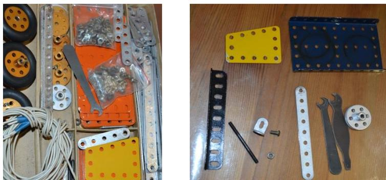
Свердловским заводом (Машиностроительный завод имени М.И. Калинина). Всего использовано 200 деталей. Среди которых - гайка, винт, ось, планка, уголок, пластина, колесо, панель. При строительстве чаще всего используется крепление с помощью винта и гайки, последовательное и вертикальное соединение.
